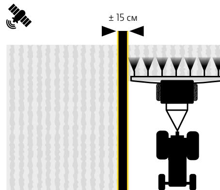
Сигнал початкового рівня зараз став ще кращим. Ви отримуєте точність від проходу до проходу  $\pm 15$  см замість попередніх  $\pm 23$  см. На безкоштовній основі та з підтримкою ГЛОНАСС.
