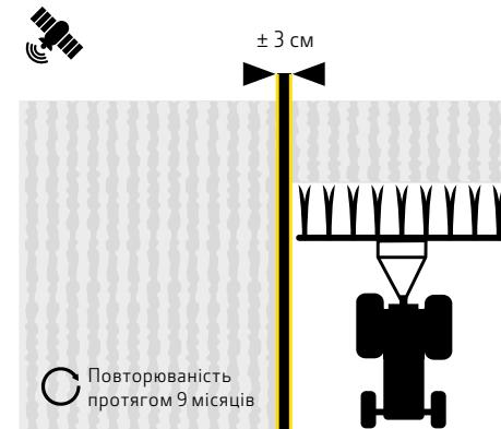
Новий сигнал SF3 забезпечує вражаючу точність  $\pm 3$  см від проходу до проходу та сезонну повторюваність впродовж 9 місяців. До того ж час отримання максимальної точності скоротився у 4 рази в порівнянні із сигналом SF2. Тож ви можете витрачати більше часу на роботу в полі, замість того щоб чекати на поворотній смузі або ставити під загрозу точність виконання робіт.
